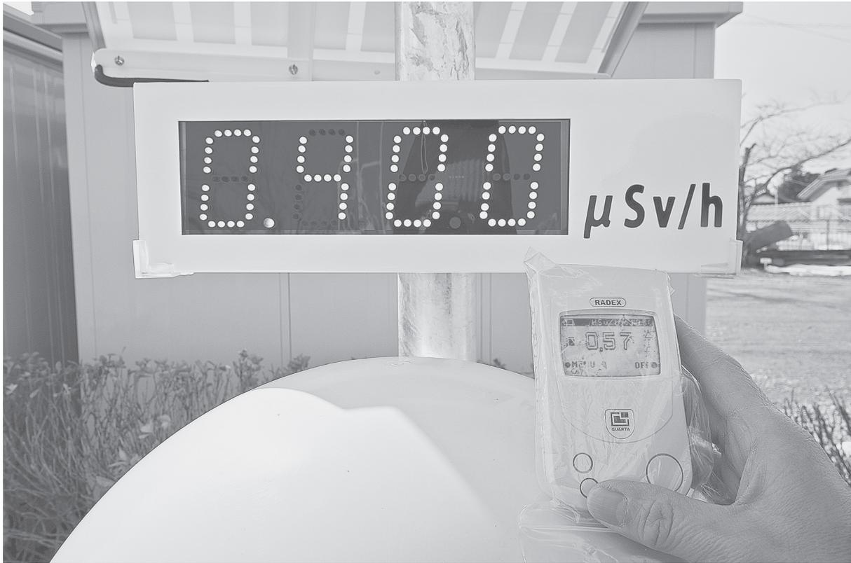
遊び場南の駐車場にモニタリングポストが設置されていた。数値は0.400を表示。手前の線量計は0.57を計測。
